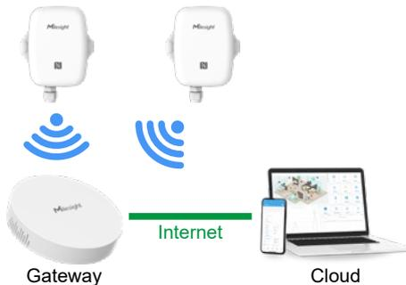
Zur Übertragung verwendet der Schalter den LoRaWAN Standard. Die Daten werden so kabellos an ein Gateway übertragen, welches mit dem Internet verbunden werden kann.
